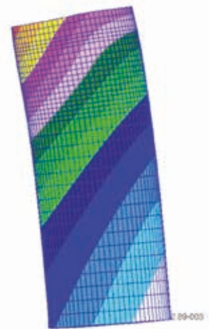
Смещение традиционного имплантата 8,5 мкм
